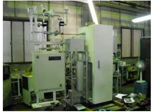
エアークontrolユニット 材質：SUS304
