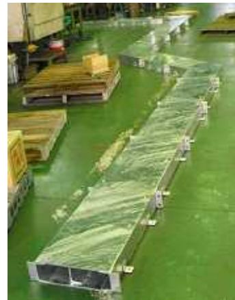
配線用ダクト 材質：SS400
