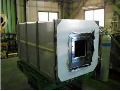
1 m 3 ステンレスチャンバー 材質：SUS304
