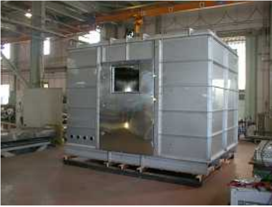
24m 3 ステンレスチャンバー 材質：SUS304
